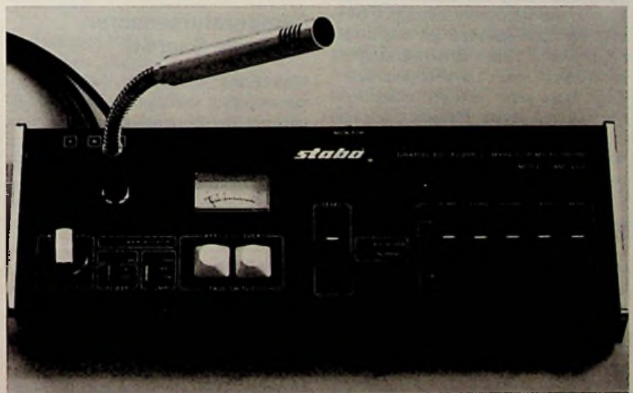
Bild 1. Besprechungsstelle für Amateurfunkstationen. Über den Drehschalter „OUTPUT“ kann immer eine von maximal 3 Amateurfunkstationen (A, B, C) mit dem Mikrofonsignal versorgt werden (Stabo)
